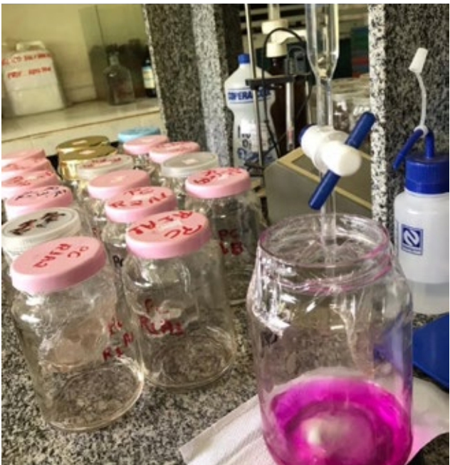
Figura 3 – Titulação das amostras em laboratório (Fonte: autores, 2021)
