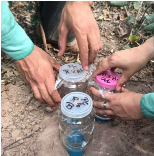
Figura 1 – Frascos-amostras com solução de KOH (Fonte: autores, 2021)
