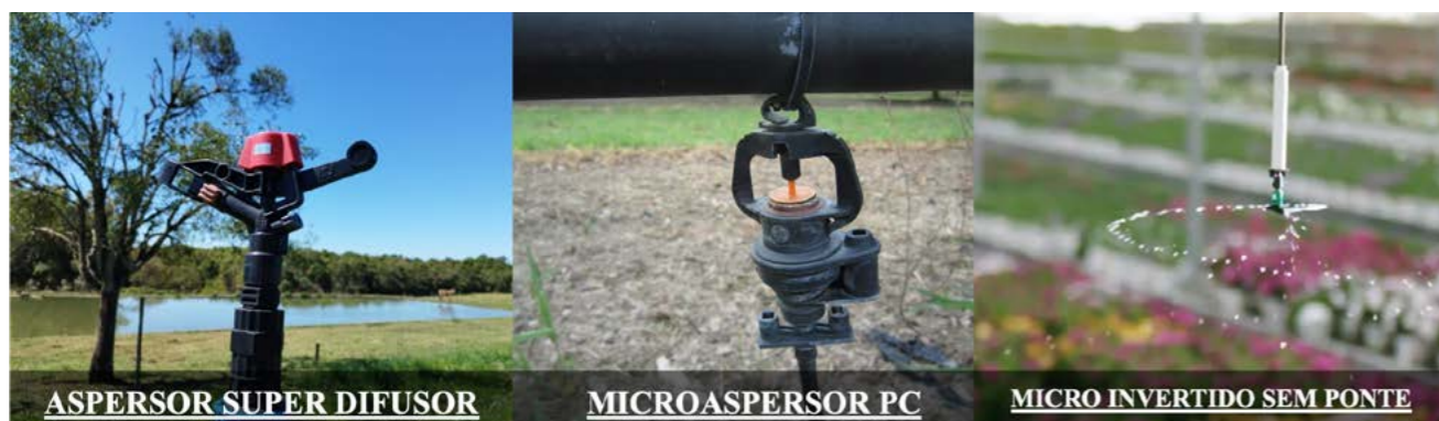
Figura 1. ASPERSOR SUPER DIFUSOR: tecnologia de dispersão de água através de sulcos que aumentam a uniformidade de aplicação em aspersão. MICROASPERSOR PC: tecnologia de compensar variação de pressão para manter vazão e possibilidade de asa com dois estágios. MICRO INVERTIDO SEM PONTE: uniformidade otimizada e aplicação sem escorrer pela ponte (minimiza desenterrio de sementes em bandejas e doenças fúngicas embaixo do emissor).
