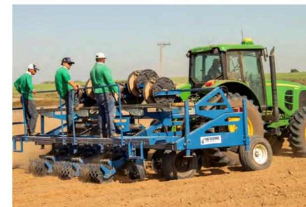
Figura 03- Implemento utilizado para o enterrio dos tubos gotejadores
