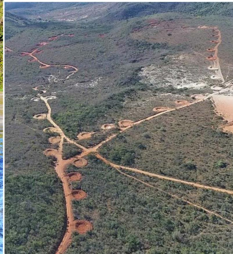
**FIGURA 1** - Área de recarga com intervenções técnicas (barraginhas) voltadas ao controle do escoamento superficial de água da chuva advindo das estradas vicinais.
