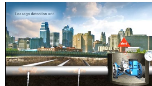
FIGURA 2 - Recebimento de Alertas de vazamento e monitoramento de vazão.
