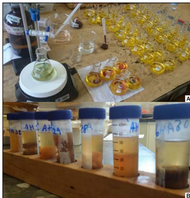
**FIGURA 2 - A - Titulação de Dicromato de Potássio em Sulfato Ferroso Amoniacal, e B – Amostras com fração de Ácido Húmico + Ácido Fúlvico prontas para centrifugação, LAPED –UFU, Uberlândia, MG, 2016.**
